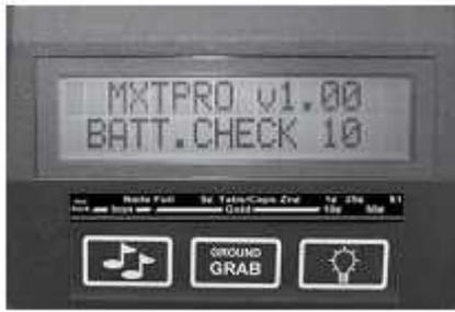
All'accensione tramite il potenziometro 5 il metal detector vi dà il benvenuto con la versione del software e lo stato del set di batterie (12 volt indica la piena carica a 8 la scarica definitiva)
