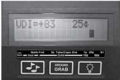
Nella parte sotto al display a cristalli c'è una scaletta con i vari probabili target relativi ai valori di VDI rilevati. Facciamo attenzione al fatto che il terreno viene rilevato dal metal come un oggetto e può indicare al metal vari segnali e relativi valori di vdi, ma il bilanciamento (manuale o automatico che utilizzate) ne esclude il segnale (abbattimento del terreno), perciò consultate il display solo dopo un segnale corrispondente alla rilevazione di un target.
