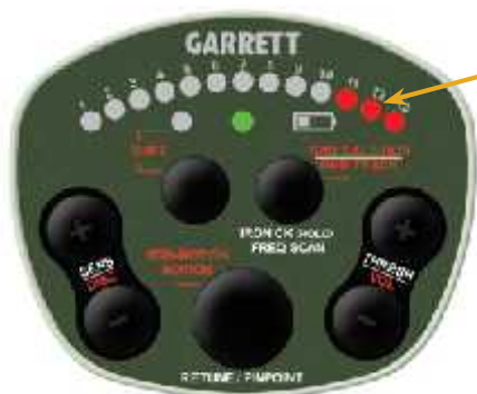
gli ultimi tre led rossi indicano il massimo livello del segnale.
